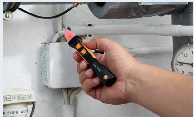
Érintésmentes feszültségmérés egy fűtőrendszer elosztódobozán a testo 745 műszerrel
